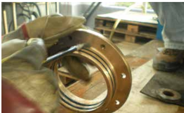
Установка и смазка O-образных колец - 3-ий шаг
