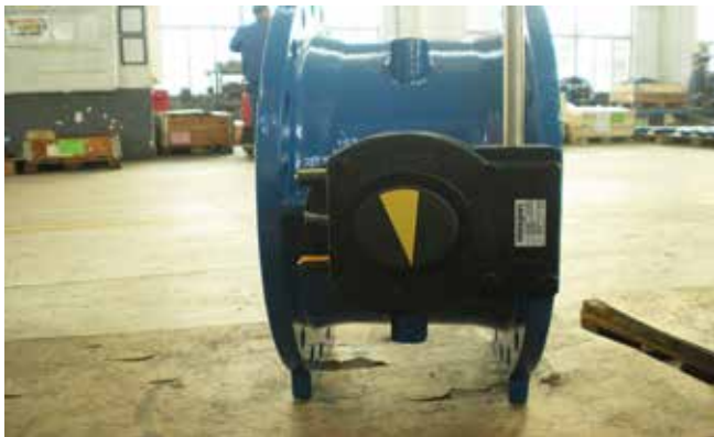
Проверка положения на индикаторе - 4-ый шаг
