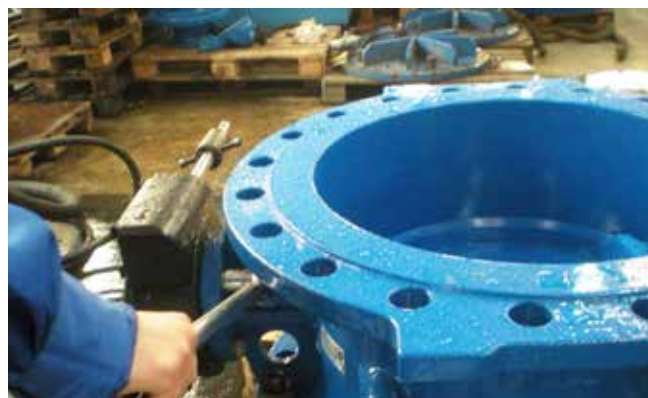
Установка редуктора - 5-ый шаг
