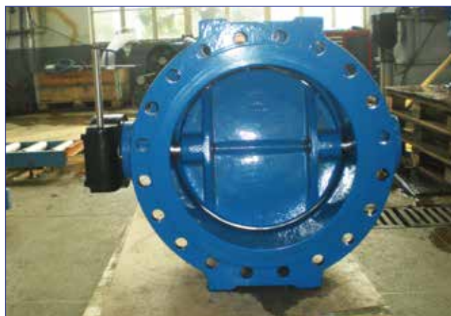
Положение стоя на фланцевых бортиках
